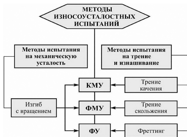
Рисунок 2 — Формирование методов износоусталостных испытаний при главном вращательном движении Figure 2 — Formation of methods of wear-fatigue tests in the main rotational motion
