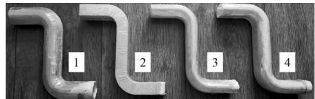
Рисунок 4 — Изготовленные модели водозаборников различных сечений: 1 — круглое; 2 — прямоугольное; 3 — эллиптическое; 4 — овальное
