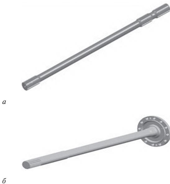
Рисунок 12 — Полуоси автомобилей МАЗ: а — цилиндрическая для большегрузного автомобиля; б — цилиндрическая с фланцем для среднетоннажного автомобиля
