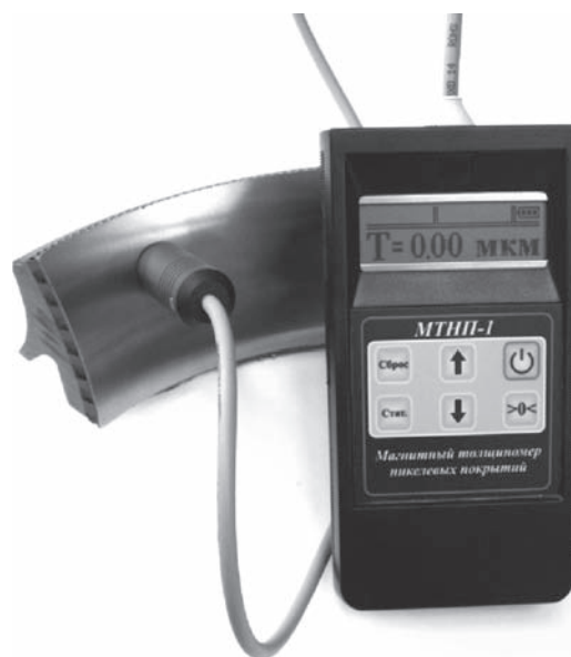
Рисунок 3 — Магнитные толщиномеры защитных покрытий: а — МТЦ-3; б — МТНП-1
