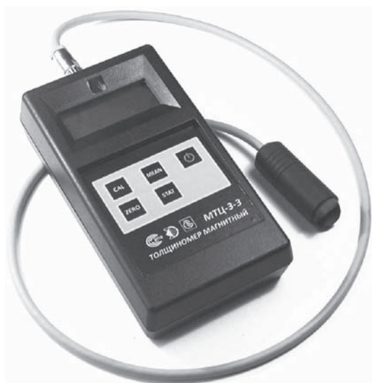
Рисунок 3 — Магнитные толщиномеры защитных покрытий: а — МТЦ-3; б — МТНП-1
