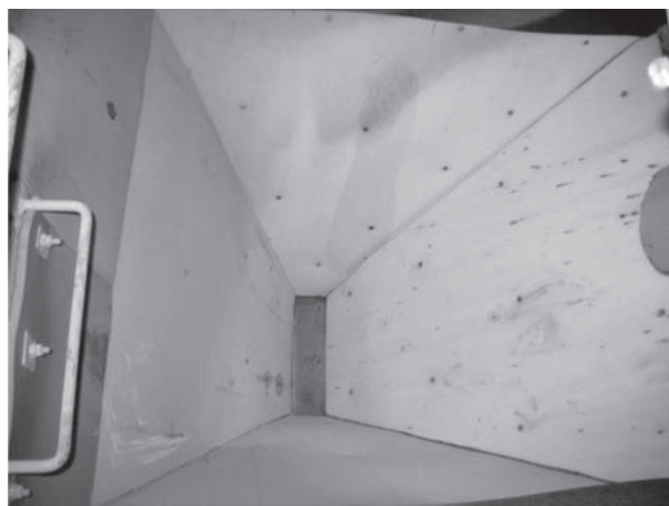
Рисунок 5 — Футеровочные плиты рудоспусков из СВМПЭ-композитов
