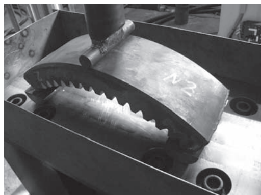
Рисунок 2 — Сервогидравлическая машина для усталостных испытаний Instron 8805: а — испытательная машина в экспериментальном цехе; б — испытания образца
