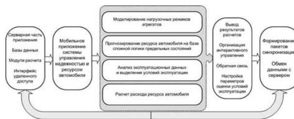
Рисунок 9 — Структура интерактивной системы управления надежностью [3, 6]
