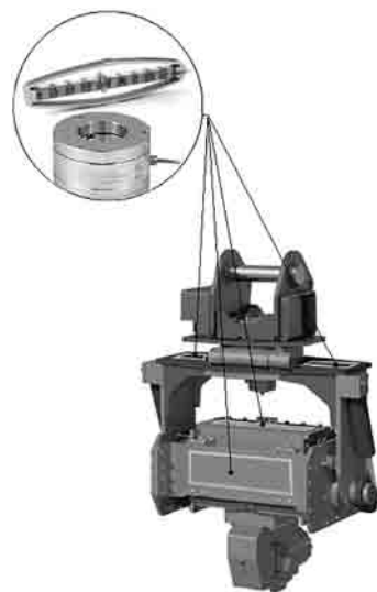
Рисунок 4 — Схема установки пьезогенераторов на вибропогружателе Figure 4 — Installation scheme of piezoelectric generators on vibratory driver
