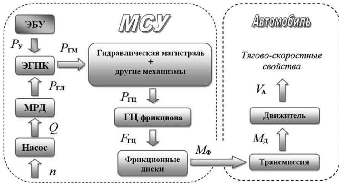
Рисунок 7 — Структурная схема МСУ и автомобиля Figure 7 — Structural scheme of mechatronic control system (MCS) and vehicle
