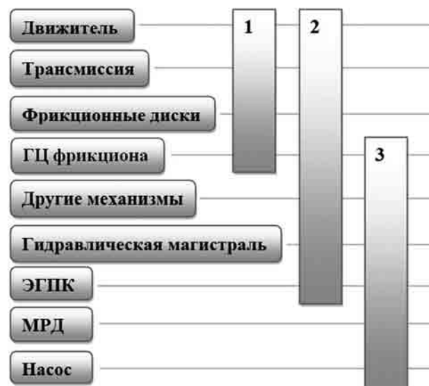
Рисунок 8 — Диаграмма элементов МСУ и автомобиля, детализируемых при имитационном моделировании:
