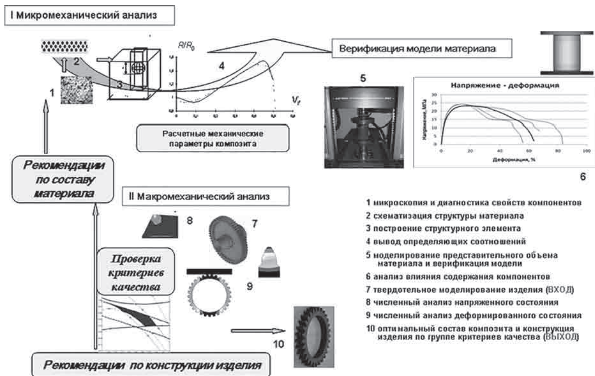
Рисунок 1 — Общая схема двухуровневого метода расчета и проектирования изделий из дисперсно-армированных композиционных материалов
