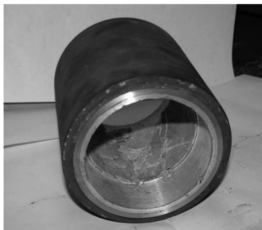
Рисунок 4 — Биметаллическая заготовка втулки № 90.31.00.062 подбивочного блока машины ВПР номенклатуры ЭРУП «Центр механизации путевых работ Белорусской железной дороги» с покрытием из силумина АК12, подслоя — порошок свинца ПС1
