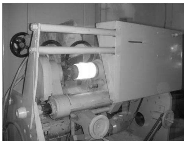
Рисунок 3 — Процесс изготовления биметаллической заготовки втулки подбивочного блока машины ВПР номенклатуры ЭРУП «Центр механизации путевых работ Белорусской железной дороги»
